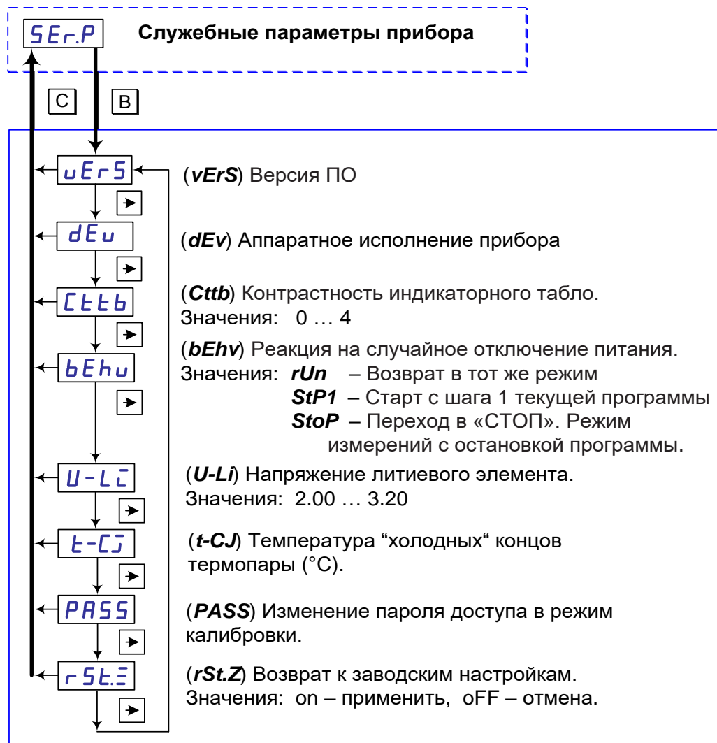
Рисунок 37 – Схема просмотра и задания служебных параметров прибора.
