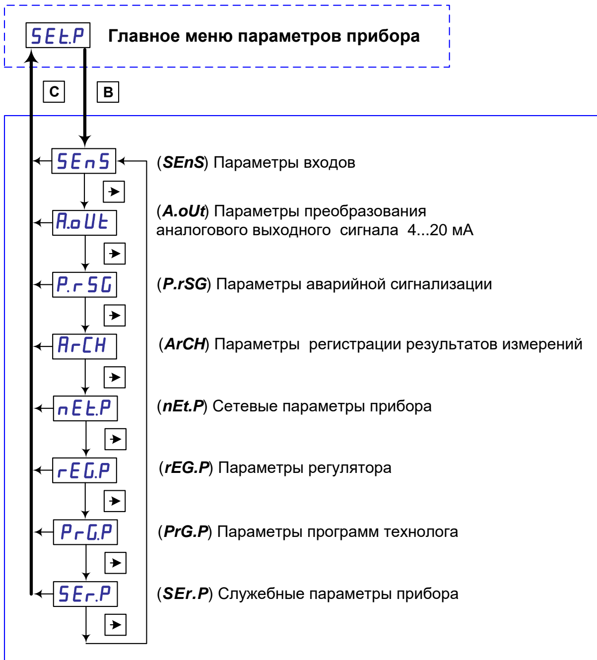
Рисунок 27 – Схема выбора групп рабочих параметров прибора.
