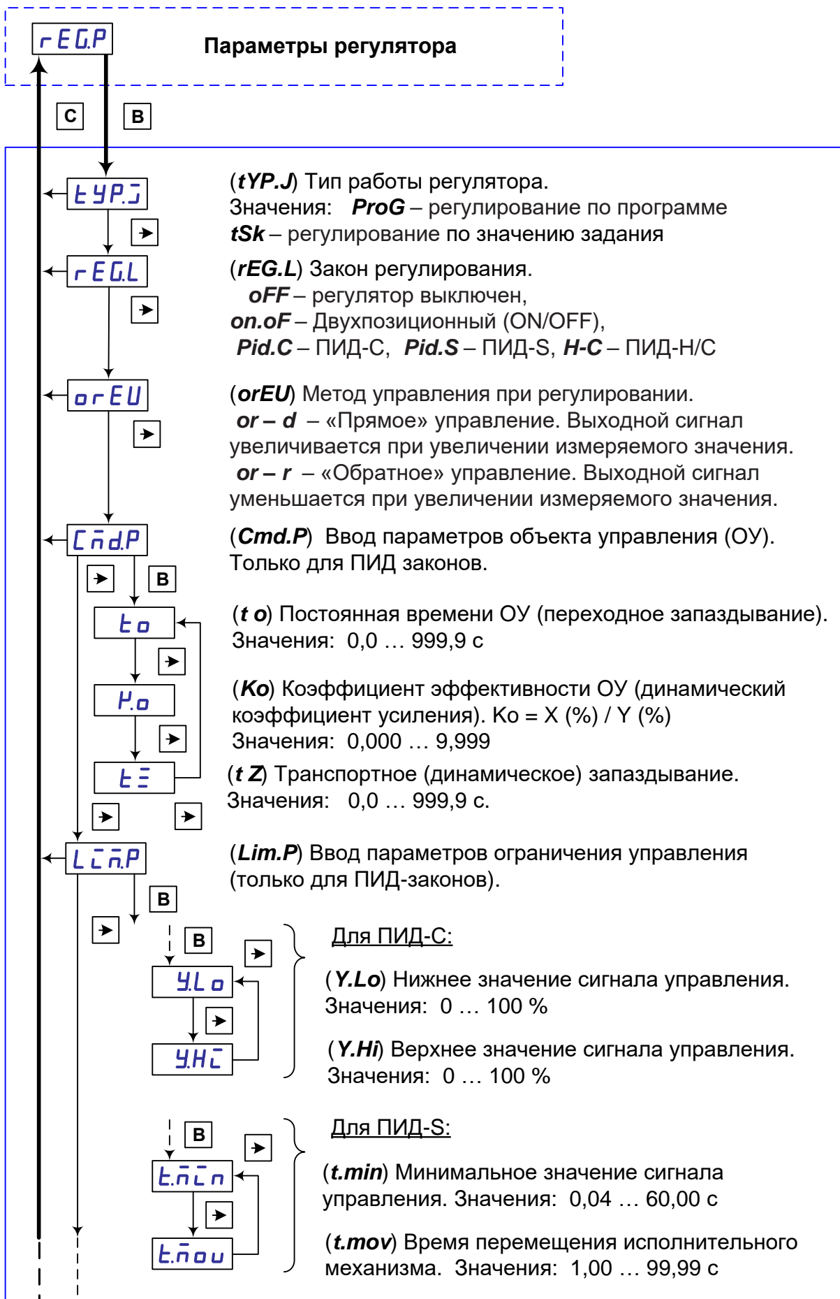
Рисунок 34 – Схема задания параметров регулирования.
