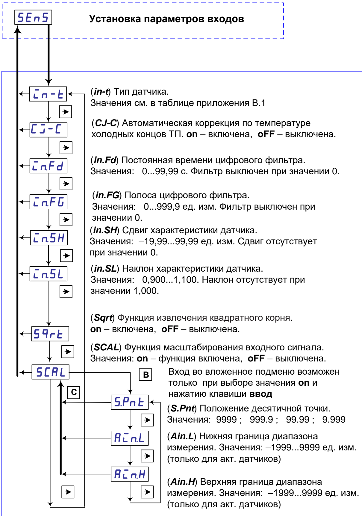
Рисунок 28 – Схема задания параметров входов.
