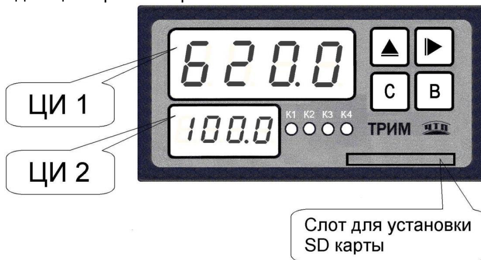
Рисунок 22 – Вид прибора со стороны фронтальной панели.
