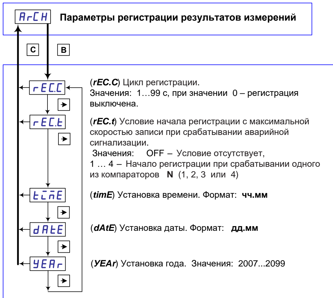
Рисунок 31 – Схема задания параметров регистрации результатов измерений.
